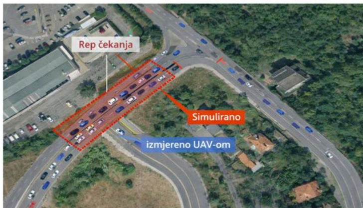
Slika 3. Kalibracija mikrosimulacijskog modela prema duljinama repova čekanja na prilazima raskrižju
